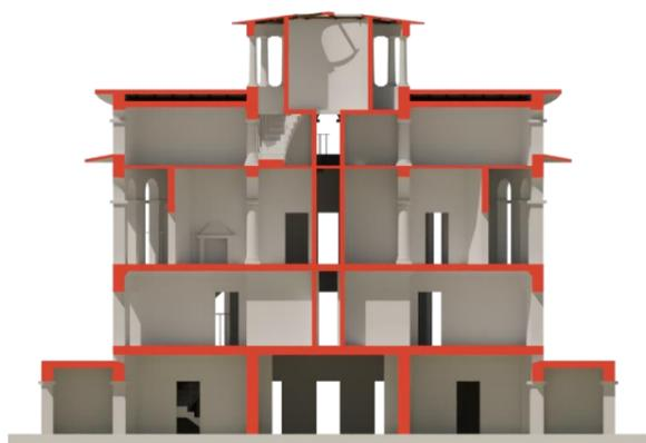
Lo studio della sezione e del prospetto che Ledoux ci ha tramandato, ha messo in luce alcune differenze dimensionali nella relazione tra interno ed esterno. dell'edificio abbiamo ridisegnato le piante secondo le aperture al piano terra, modificando la posizione di alcuni muri e di conseguenza, mantenendo la simmetria, aumentando la luce totale della costruzione.
