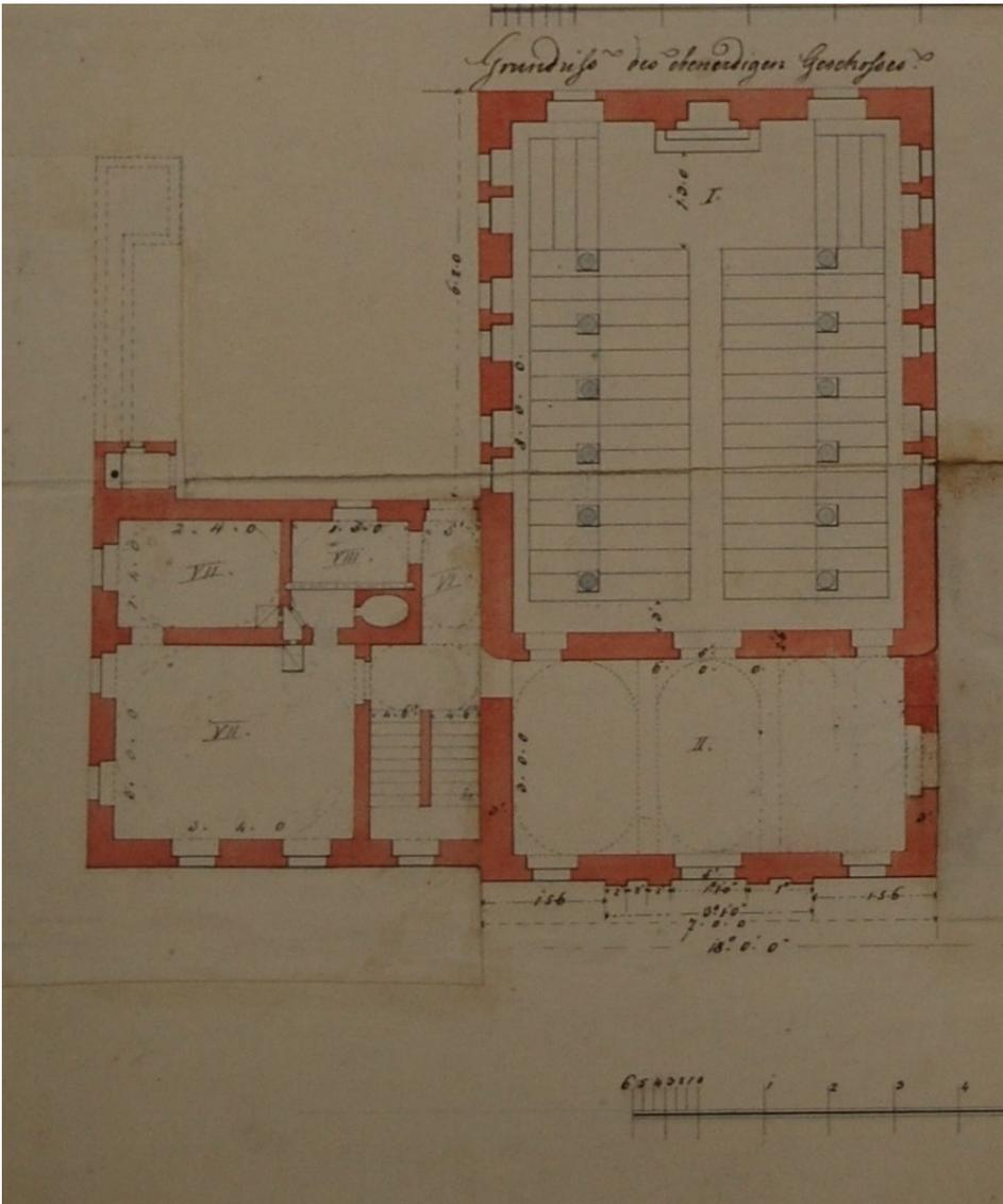
**Abb. 12** Grundriss Erdgeschoss (ohne rechten Anbau)
