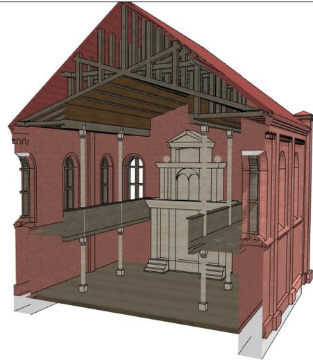
**Abb. 32** Schnitt, quer mit Einblick in die Dachbalken
