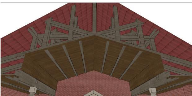
**Abb. 35** Dachstuhl mit abgehängter Decke
